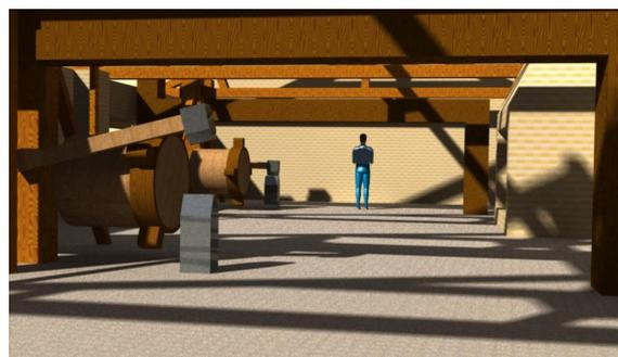
L’Affinerie sert à transformer la fonte issue des Hauts-Fourneaux en fer. Pour cela, la fonte est fondue dans des fours en présence d’un fort flux d’air afin de la décarburer. On obtient ensuite de la loupe de fer poreuse que l’on peut compacter sous les marteaux nommés Marti-nets.
