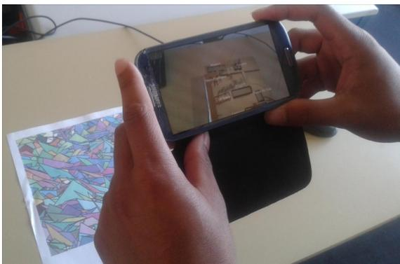
Le Smartphone analyse l'image et place la maquette par dessus. Le motif complexe permet au logiciel de savoir très précisément où il se situe par rapport à l'image dans toutes les conditions d'éclairage. Le résultat est un mélange de la réalité et du monde virtuel qui fonctionne plutôt bien. Le son s'adapte aussi en fonction
