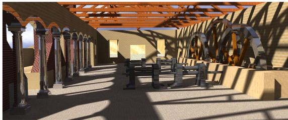
Le Laminoir est utilisé pour produire de longues pièces de métal tels des rails de chemin de fer. La fonte est tout d’abord transformée en fer dans des fours à Puddler : tout comme un four à réverbère le feu n’est pas en contact avec le métal, mais le charbon de bois est remplacé par du coke<sup>4</sup> et des composants chimiques sont placés dans le laboratoire. Le fer est ensuite réchauffé dans des fours à réverbère et passe ensuite entre les rouleaux du Laminoir.
